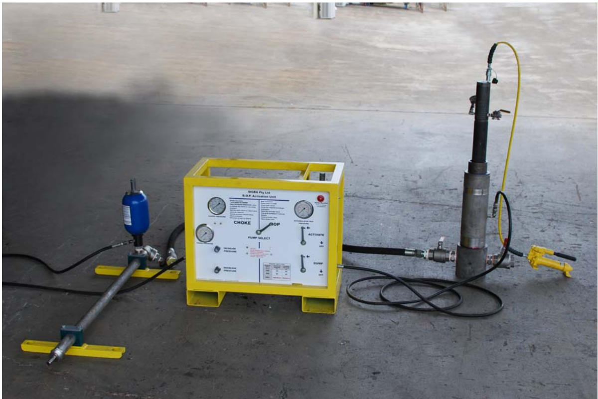
Дроссель, блок активации и ПВП с присоединенным устьевым уплотнителем. Низкопрофильная шламовая труба не показана
