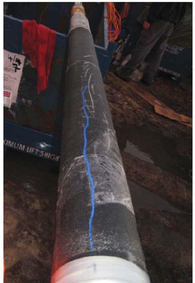
След от трещины на пакере-печати
