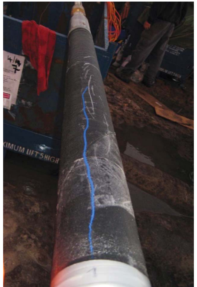
压印器上的裂缝迹线
